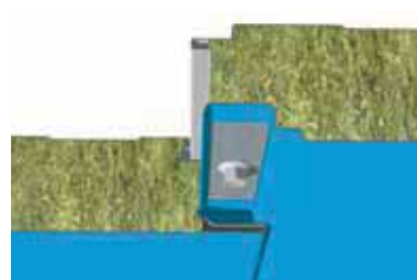
Montaggio dei pannelli in senso verticale
