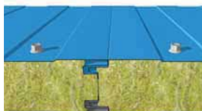
Montaggio dei pannelli in senso verticale
