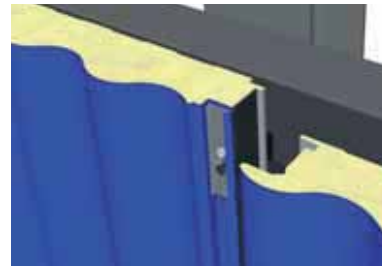
Montaggio dei pannelli in senso verticale
